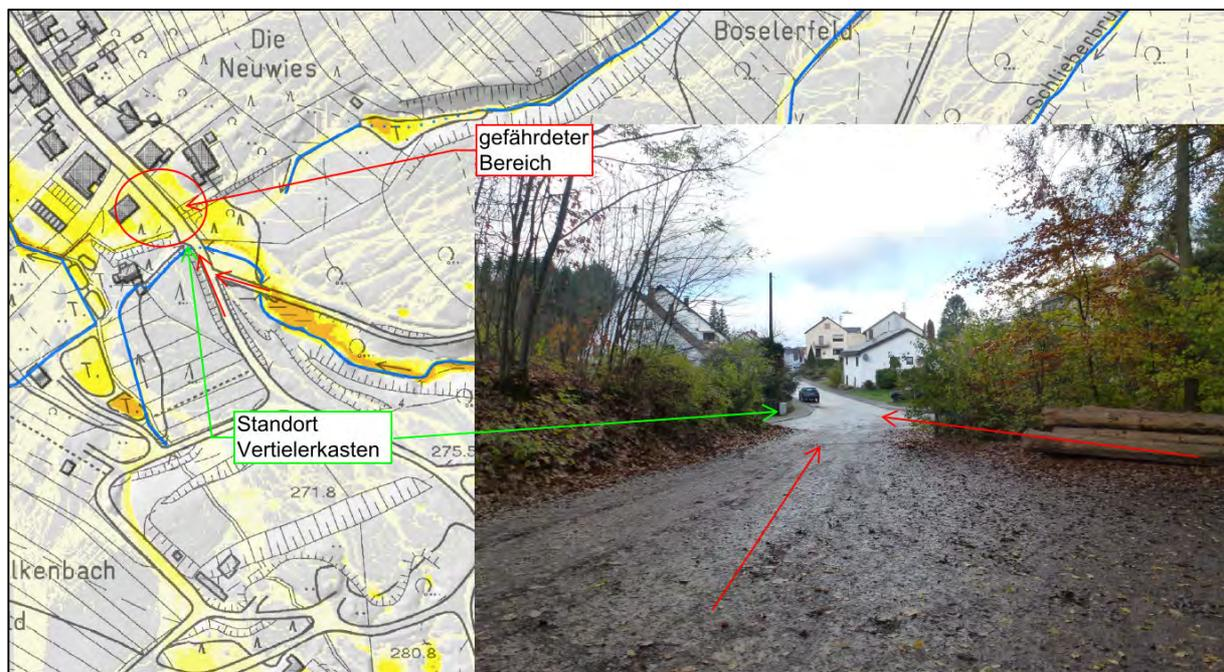
Abbildung 47: Gefährdeter Bereich bei Überlastung Durchlässe Mäusbach
