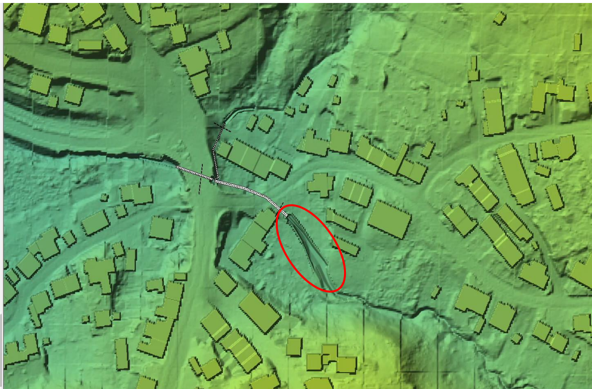
Abbildung 8: Lage Hochwasserschutzmauer in DGM
