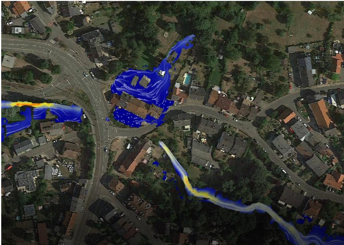
Abbildung 9: Simulation der Belastung am Einlaufbauwerk Mäusbach
