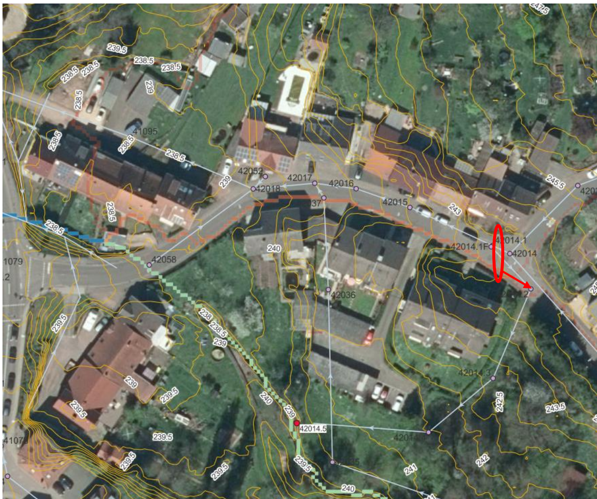
Abbildung 18: Querrinne mit Anschluss an Entlastungsleitung
