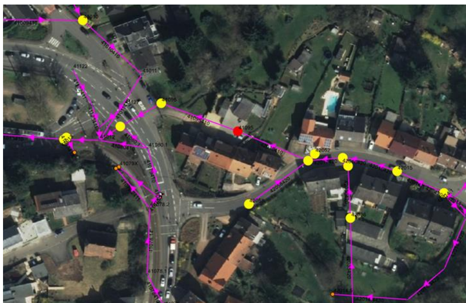
Abbildung 17: Schacht (rote Markierung) mit Überstau bei Ausführung Hochwasserschutz Hahnhümes
