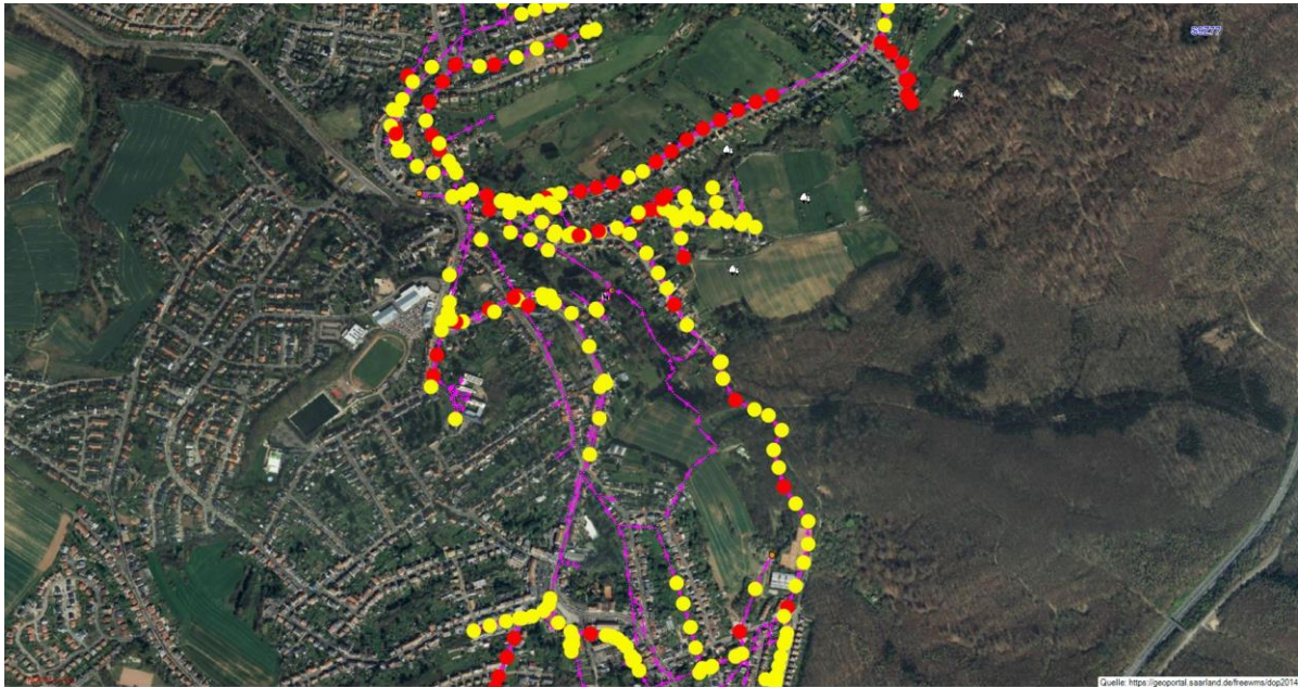
Abbildung 2: Schächte mit Überstau bei Regenereignis D120,T100
